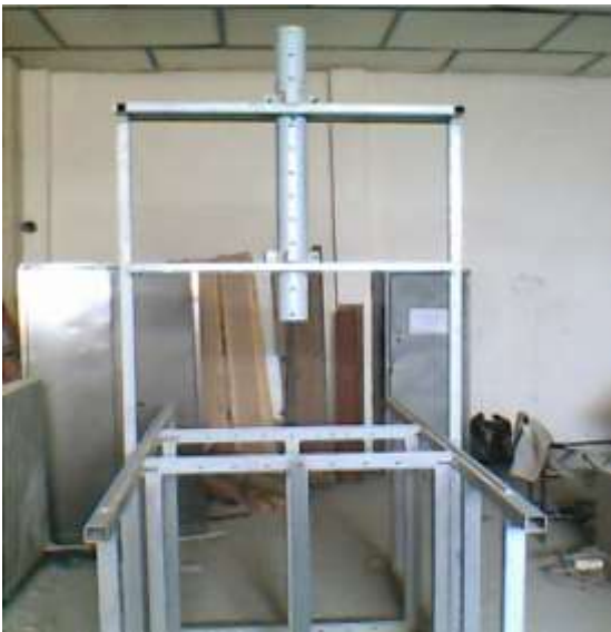
Fig.3 : Impact test rig
