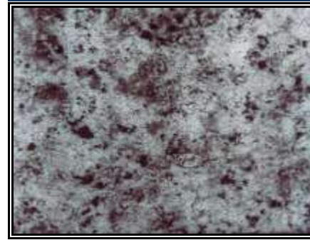
الشكل (١٠) : الفحص المجهرى للمركب \text{Bi}_{2-x}\text{Hg}_x\text{Ba}_2 تحت ضغط هيدروستاتيكي 8 \text{ ton / cm}^2 ودرجة حرارة تليدين (850^\circ\text{C}) عندما x=0.2 و y=0.2 و \text{y} \text{sr}_y\text{Ca}_2\text{Cu}_3\text{O}_{10+\square}
