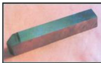
الشكل (3) عدة قطع من نوع صلب السرعات العاليه
