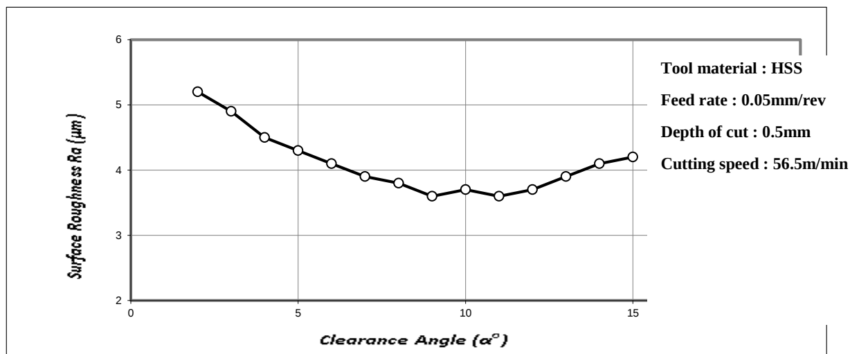
الشكل (4) منحنى الخلوص – الخشونة عند (معدل تغذية 0.05mm/rev وعمق قطع 0.5mm وسرعة قطع 56.5m/min)
