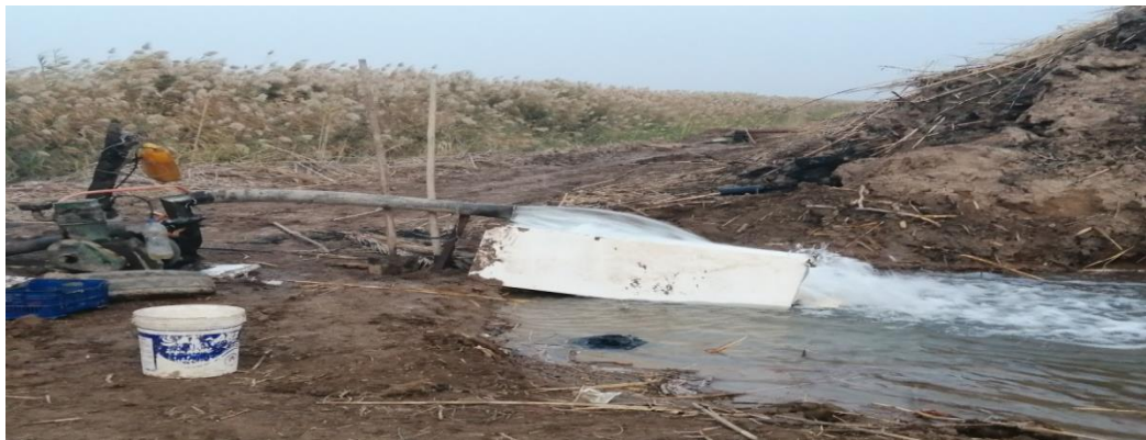
الصورة(5) توضح مضخة ماء تعمل بالكاز على قناة أروائية
