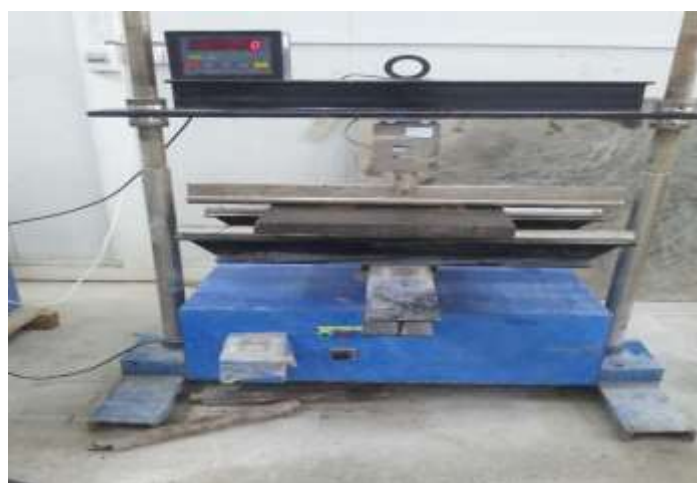
صورة رقم (5): توضح جهاز فحص بلاطات الفيروسمنت
