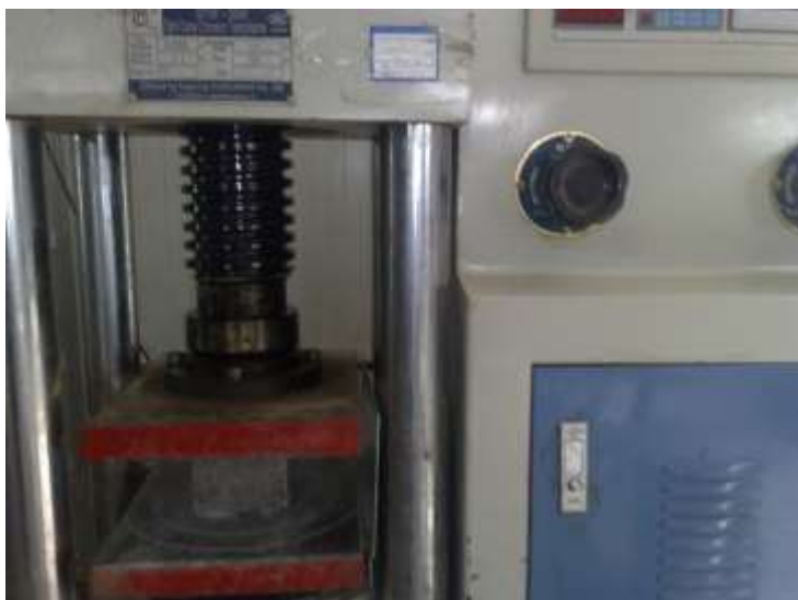
صورة رقم (2): توضح جهاز فحص مقاومة الانضغاط للمكعبات الخرسانية
