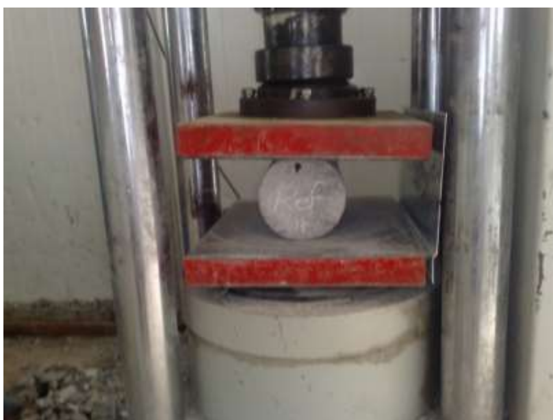
صورة رقم (3): توضيح جهاز فحص مقاومة الانضغاط لفحص مقاومة الشد غير المباشر للأسطوانات الخرسانية
