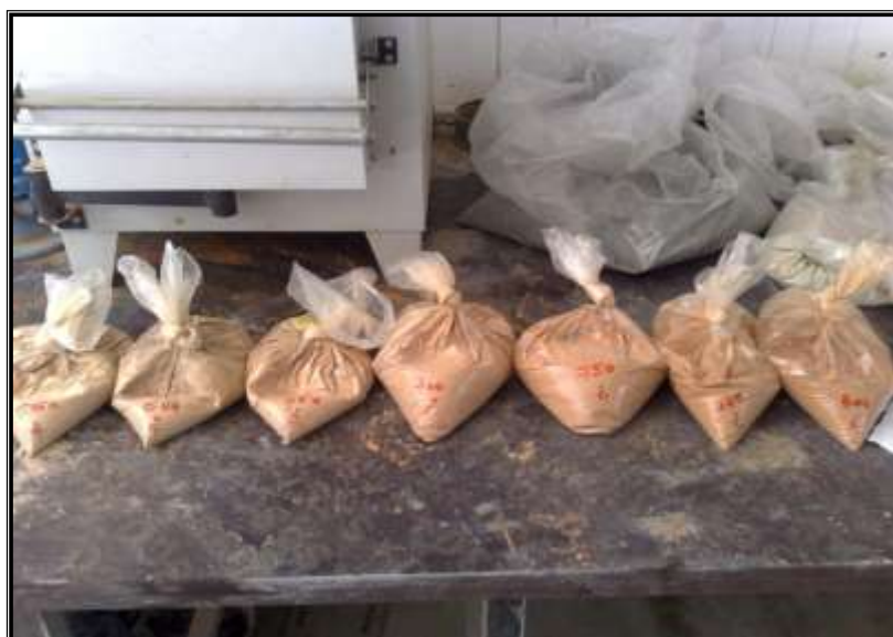
صورة رقم(1): توضح المضاف المعدني بعد حرقه بدرجة حرارة 750 درجة سيليزية.
