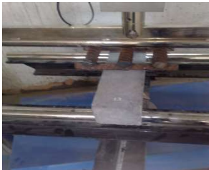
صورة رقم (4): توضح جهاز فحص معايير الكسر للمواشير الخرسانية
