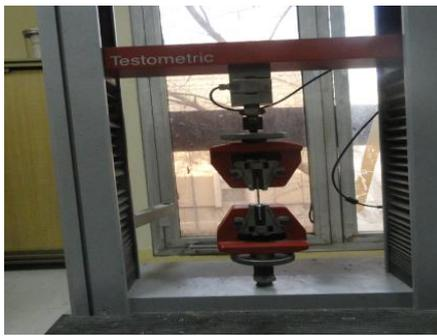
Fig.6 tensile tester (testometric)
