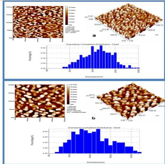
**Fig3. AFM images of a: CdS b: CdS:7.5%Al**
