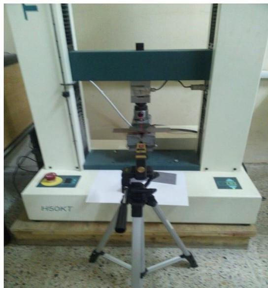
Fig (3): The V-bending test
