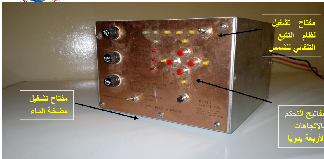
شكل (3) يوضح صندوق السيطرة الرئيسي لمنظومة التتبع التلقائي للشمس
