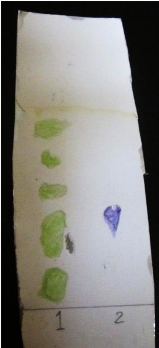
الشكل ٢ المركبات المفصولة بوساطة تقنية كروماتوغرافيا الطبقة الرقيقة TLC حيث يمثل رقم 1 زيت الصبار ورقم 2 حامض الساليسليك القياسي
