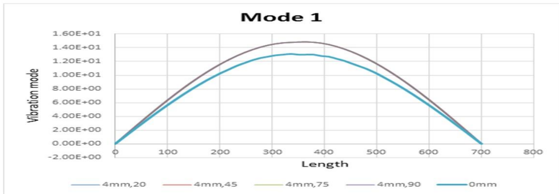
الشكل (23) يوضح شكل الطور الاول عند العمق (4mm) مع اختلاف الزاوية
