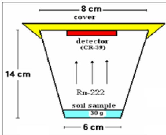
شكل (1) عملية تعرض الكاشف للرادون باستخدام تقنية القدرح
