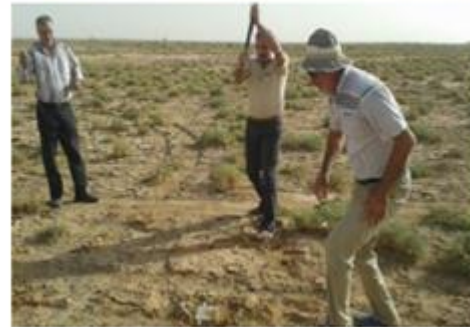
صورة (2) نشر الجيوفونات مع الكيبلات لحظة اجراء الضربات مع التسجيل
