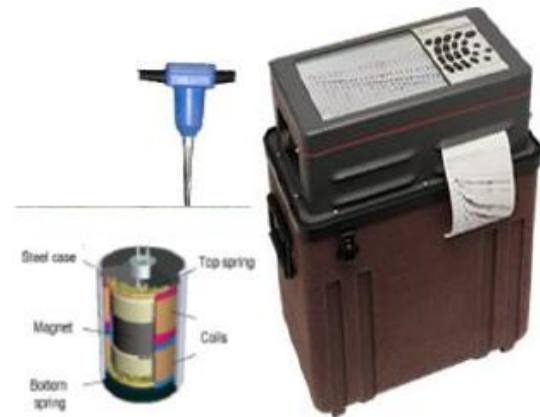
صورة (1) جهاز السيزموغراف (Strata Visor-NZ) مع جيوفون نوع (P-wave) ومقطع عرضي للجيوفون
