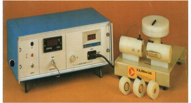
الشكل (١) يبين صورة توضيحية لجهاز قياس الموصلية الحرارية
