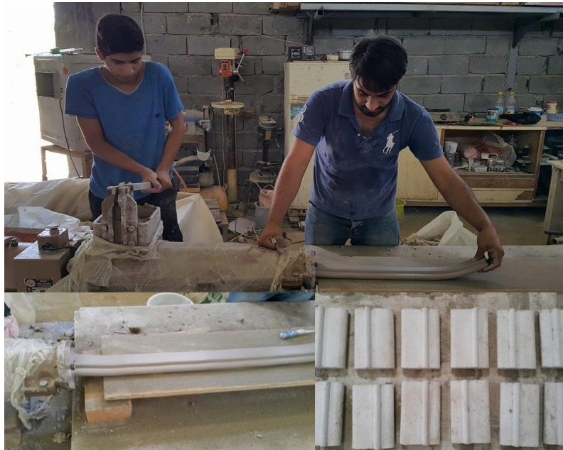
الشكل (٣-١) يوضح تشكيل النماذج باستخدام ماكينة Pugmill Clay
