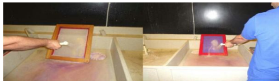
شكل (٦) يوضح غسل الشاشة لاستخدامها في تصميم اخر
