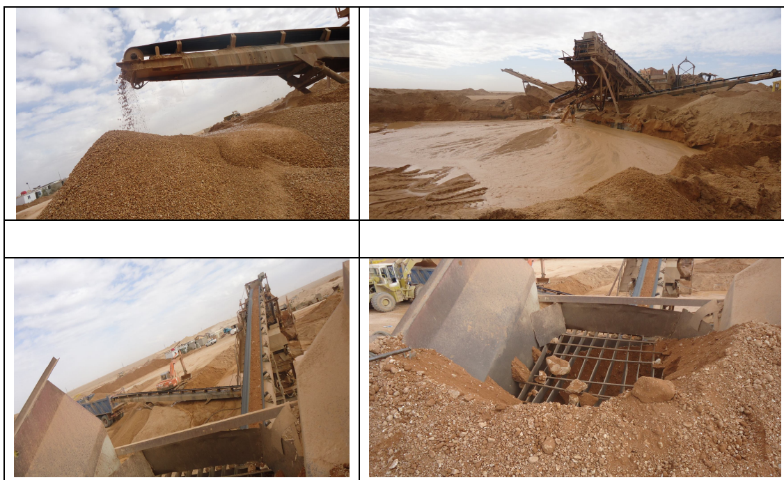
الشكل (٤) يوضح عملية فصل مكونات الحصى الخابط وعزل الأطنان.
