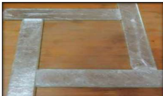
الشكل (3) القالب المستخدم في عملية صب الخلطات
