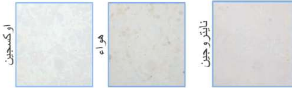
الشكل (2) صور المجهر الضوئي للأغشية المرسبة باختلاف الغاز الناقل
