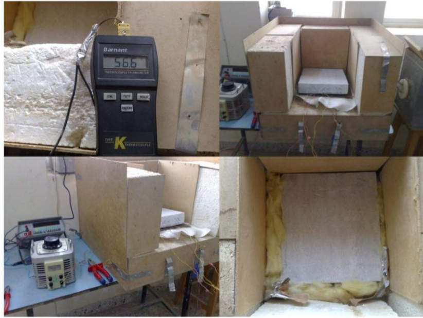
لوحة (2) توضح الجهاز والمحولة وجهاز قياس درجات الحرارة.
