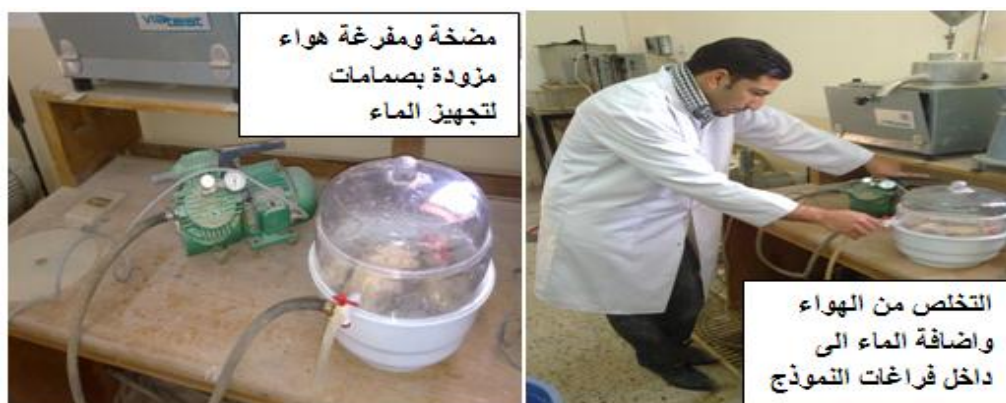
صورة (1) جهاز تفريغ الهواء المستخدم في قياس المسامية الكلية مزود بمصدر مجهز للماء
