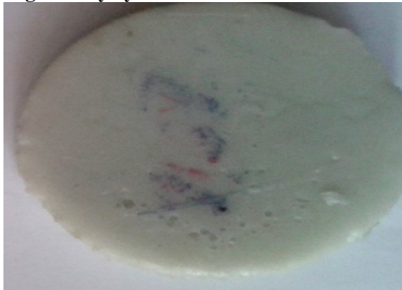
Fig. 4. Polystyrene – 20 wt % nano alumina
