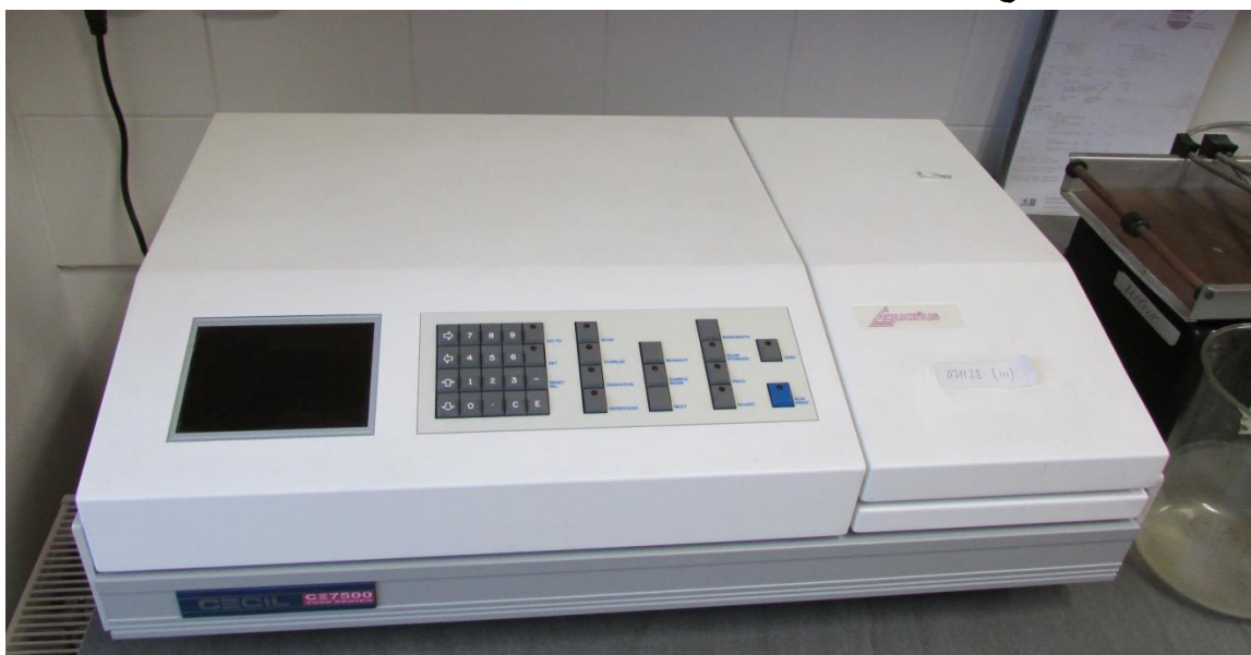
شكل رقم (٢): جهاز المطياف المستخدم لايجاد تراكيز المواد في المحاليل المختلفه
