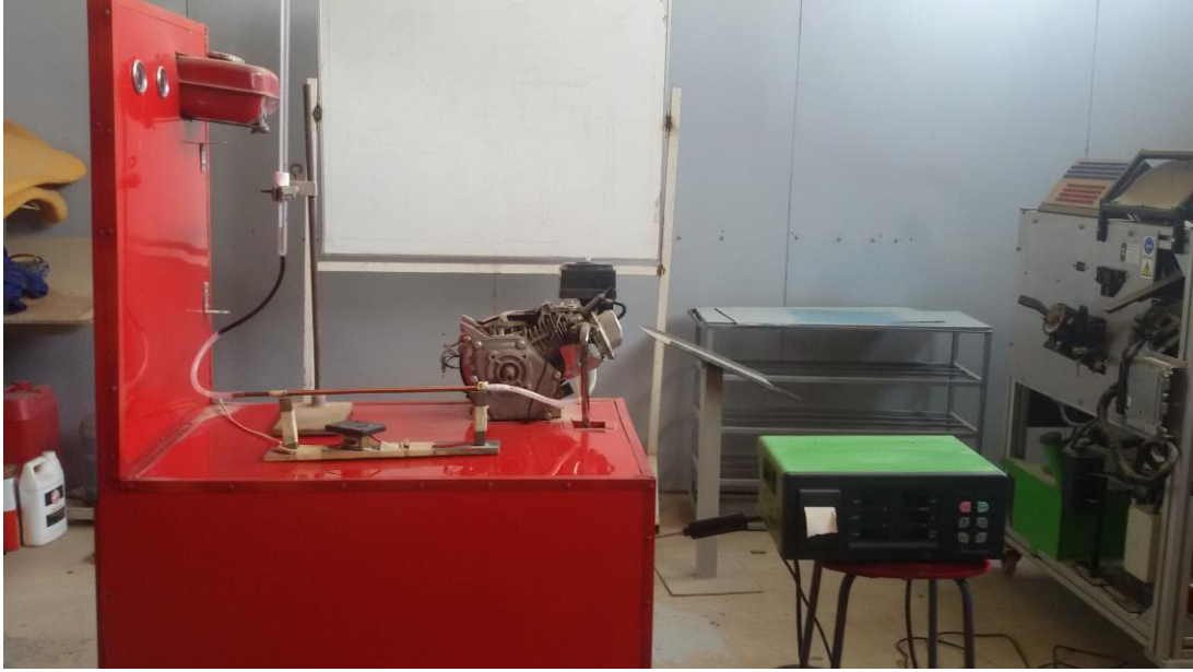
الشكل ( ١ ) الاجهزة المستخدمة ( جهاز المغنطة - محرك رباعي الاشواط - جهاز قياس غازات العادم ) .
