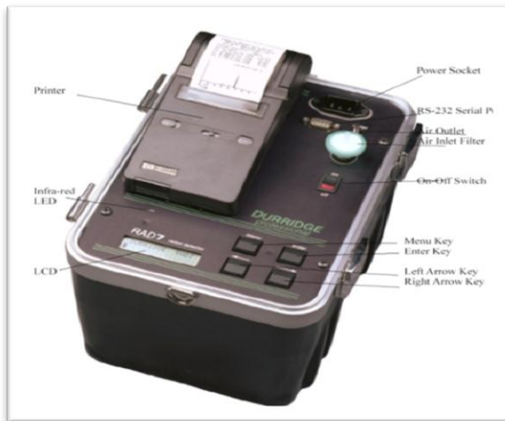
الشكل (2-1) الكاشف RAD7 مع التأثيرات [5]. للكاشف RAD7 مواصفات متميزة نذكر أهمها من خلال الجدول (1-1).
