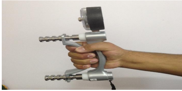
الشكل (١) يوضح كيفية قياس قوة القبضة لعينة البحث
