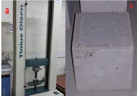
شكل (2) (a) نموذج لفحص مقاومة الإنشاء (2x2x10) سم. (b) نموذج لفحص مقاومة الإنضغاط (10x10x10) سم.
