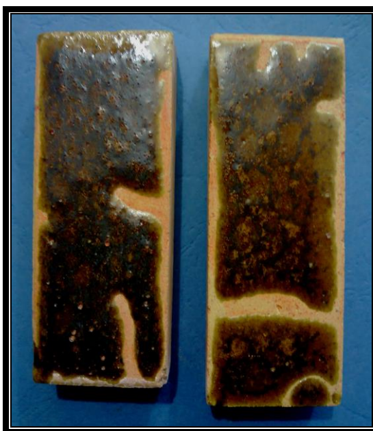
شكل رقم ( 2 ) تكتل الزجاج على سطح فخار طينة الكاؤولين
