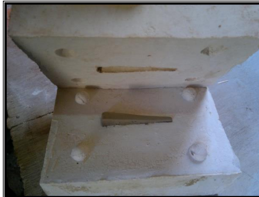
شكل (3) يبين قالب من الجبس لنموذج المخروط
