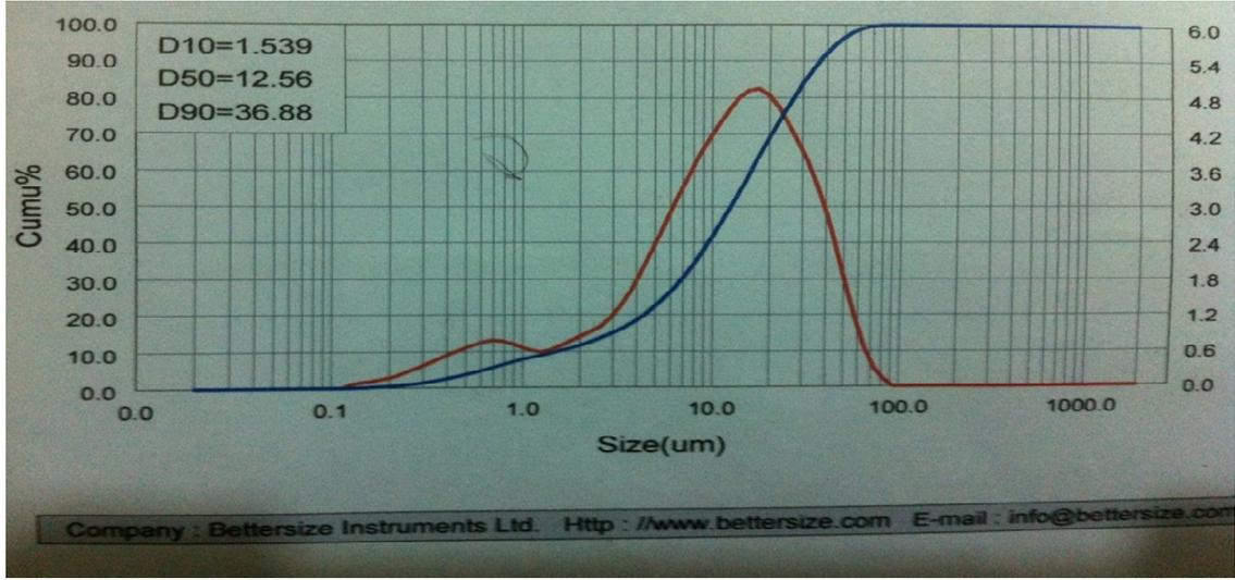
الشكل (2) الحجم الحبيبي لمادة الغبار المتطاير باستعمال جهاز (Battersize2000 laser particle size analyzer)
