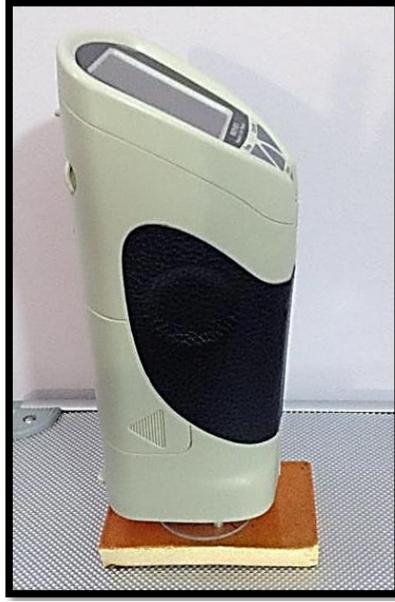
شكل (2-3)، جهاز التحليل اللوني بنظام (L.a.b)
