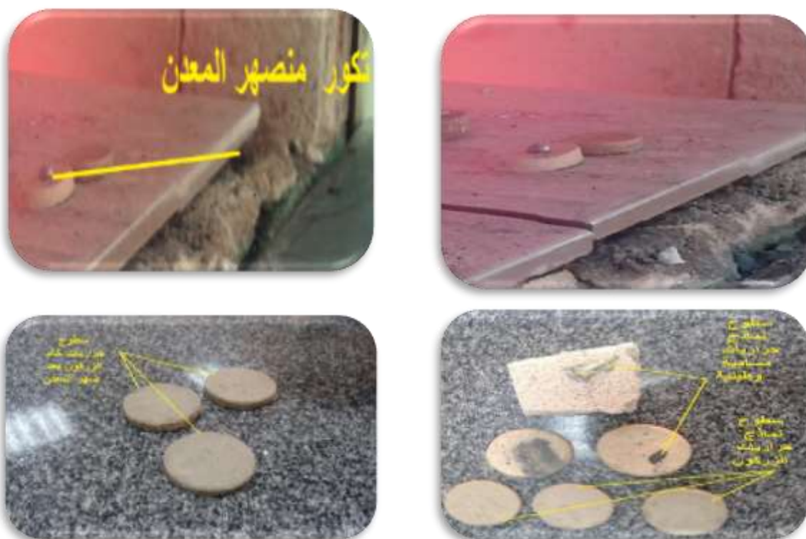
شكل (8) يوضح سطح الحراريات داخل الفرن وبعد اخراج النماذج من الفرن.
