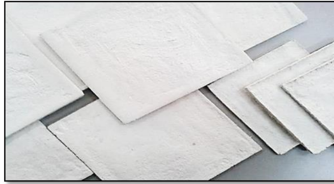
شكل 1: نماذج اختبار العزل الصوتي.
