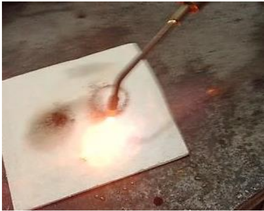
شكل 14: اختبار مقاومة الاحتراق (سطح النموذج) بعد التعرض للهب الشعلة.
