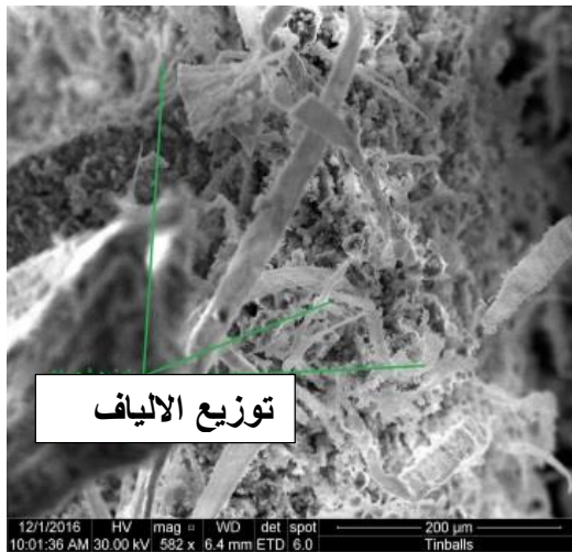
شكل 7: البنية المجهرية للخلطة (C2) المحضرة من اضافة عجينة الورق والماء للإسمنت الابيض.
