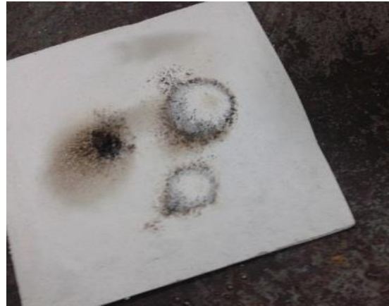
شكل 14: اختبار مقاومة الاحتراق (سطح النموذج) بعد التعرض للهب الشعلة.
