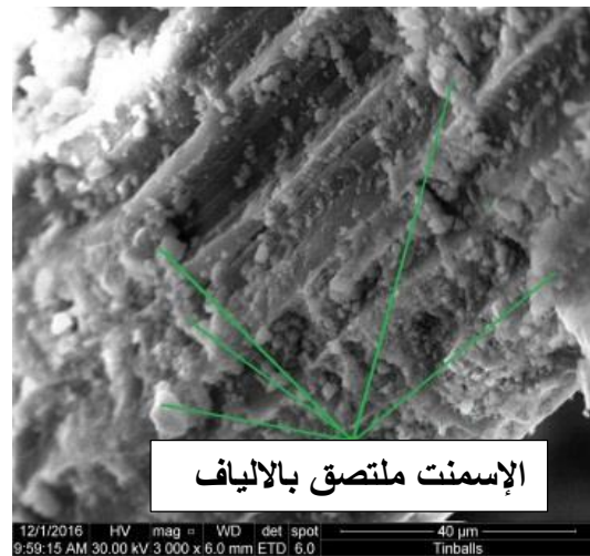
شكل 7: البنية المجهرية للخلطة (C2) المحضرة من اضافة عجينة الورق والماء للإسمنت الابيض.
