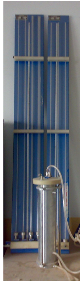
الشكل (1): الجهاز المستخدم في تجربة النفاذية ذي الارتفاع الثابت
