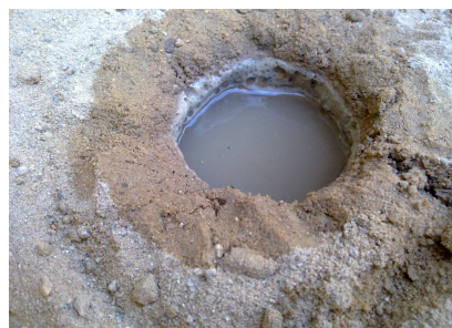
(c): مرحلة إضافة الماء لحين تشبع التربة (d): مرحلة تسجيل نزول الماء مع الزمن (e): مرحلة ثبوت نزول الماء مع الزمن
