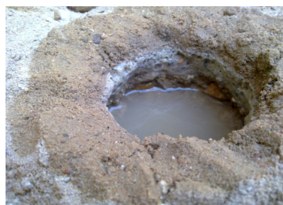
(c): مرحلة إضافة الماء لحين تشبع التربة (d): مرحلة تسجيل نزول الماء مع الزمن (e): مرحلة ثبوت نزول الماء مع الزمن
