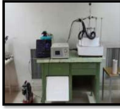
شكل(9)جهاز قياس معامل التوصيل
