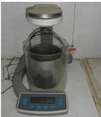
الشكل (3) جهاز قياس الوزن النوعي
