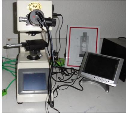
الشكل (1) جهاز قياس الصلادة
