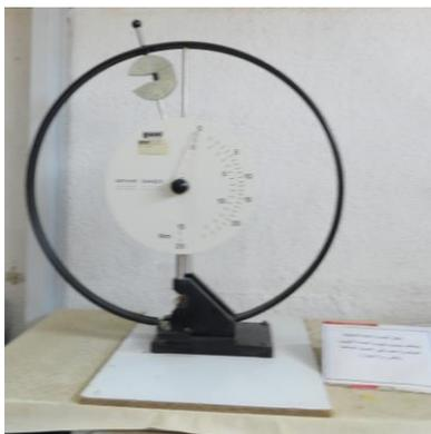
الشكل (2) جهاز قياس مقاومة الصدمة
