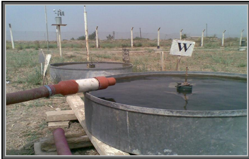
صورة رقم 1. أحواض التبخر صنف A لمياه عادية ومغنطة.
