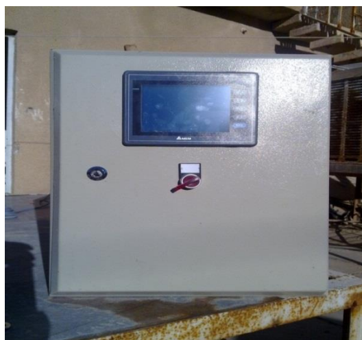
شكل (7): صورة خارجية للتحكم المنطقي المبرمج (PLC) المستخدم في المشروع البحثي
