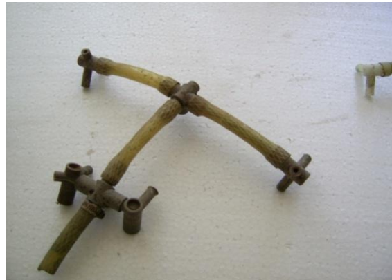
الشكل (1) مظهر علوي من آلية تحريك المياه التي ترتبط بمضخة الماء لتحريك المياه تحت نبات عدس الماء.
