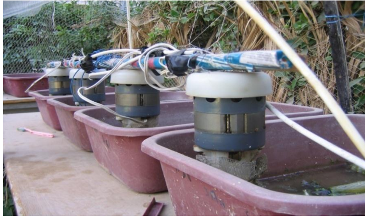
الشكل (3) المنظومة متكاملة ومرتبطة بمنظم للوقت يعمل ويتوقف بشكل متناوب لمدة نصف ساعة.
