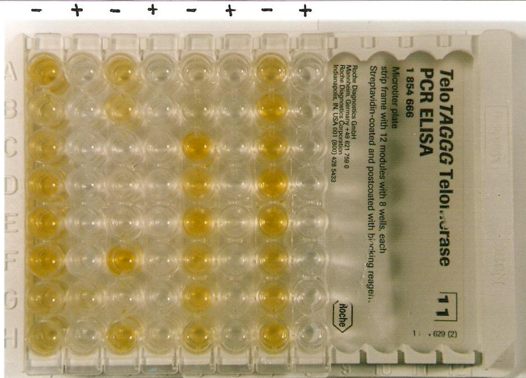
شكل (3): يوضح صفيحة المعايرة المجهرية (MTP) المحتوية على العينات الموجبة والسالبة لفحص TRAP (اللون الأصفر يدل على النتيجة الموجبة) ، (+) تدل على العينات المعاملة بالأنزيم المحطم للRNA ، (-) تدل على العينات الغير معاملة بالأنزيم المحطم للRNA
