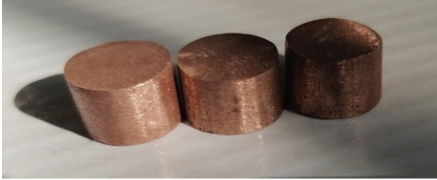
شكل (3) العينات الناتجة بعد اجراء عملية الكبس.
