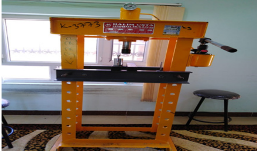
شكل (2) المكبس الهيدروليكي المستخدم.
