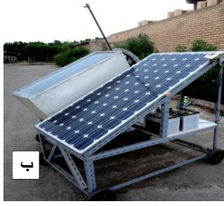
الشكل رقم (1). المجفف الشمسي تحت التفريغ المصنع محليا
