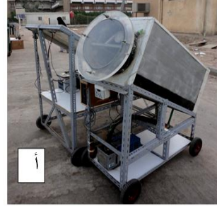
الشكل رقم (1). المجفف الشمسي تحت التفريغ المصنع محليا
