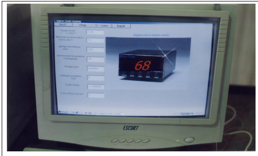
شكل رقم (2) : يوضح برنامج حاسوبي لجهاز قياس الانفعال الديناميكي
