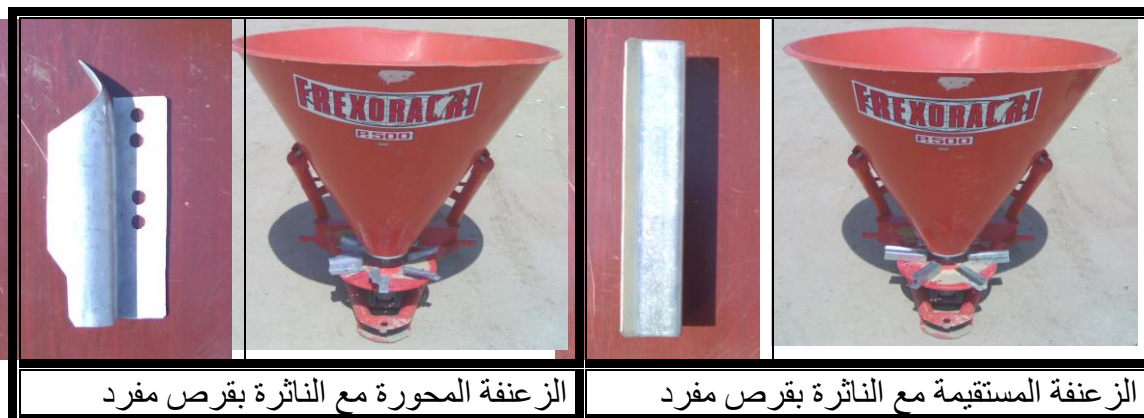
الشكل (1) يبين الزعنف المحورة والمركبة بجزئين جزء مقوس وجزء مع النائرة بقرص مفرد
