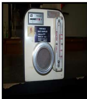
شكل (١). جهاز جمع سحب الهواء نوع سنفر لجمع عينات PM (PM type Sniffer)
