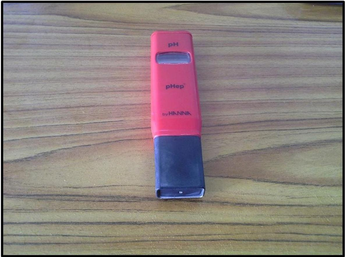
شكل (٤) جهاز PH-meter
