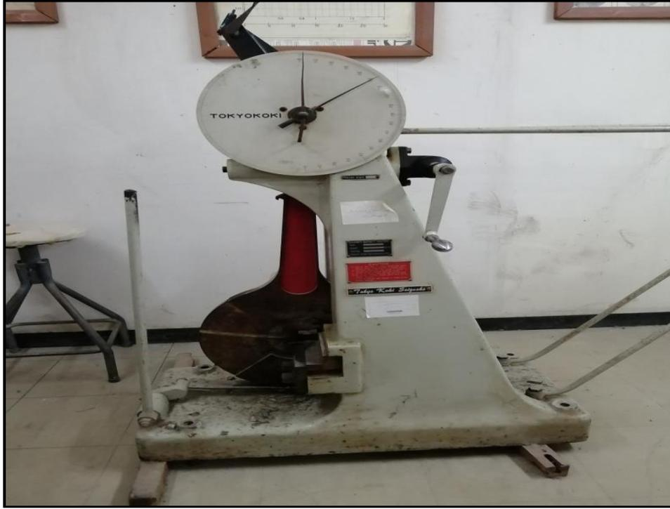
الشكل (٢) جهاز اختبار الصدمة
