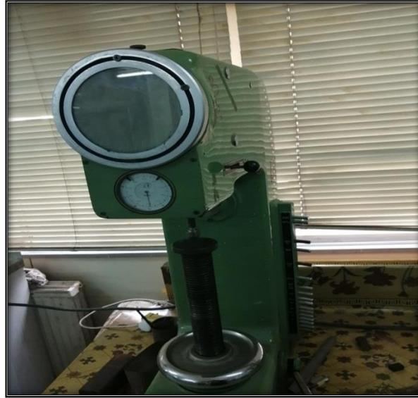
الشكل (١) جهاز اختبار الصلادة
