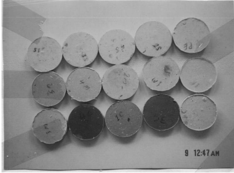
شكل رقم (3) صورة فوتوغرافية لعينات اختبار الموصلية الحرارية
