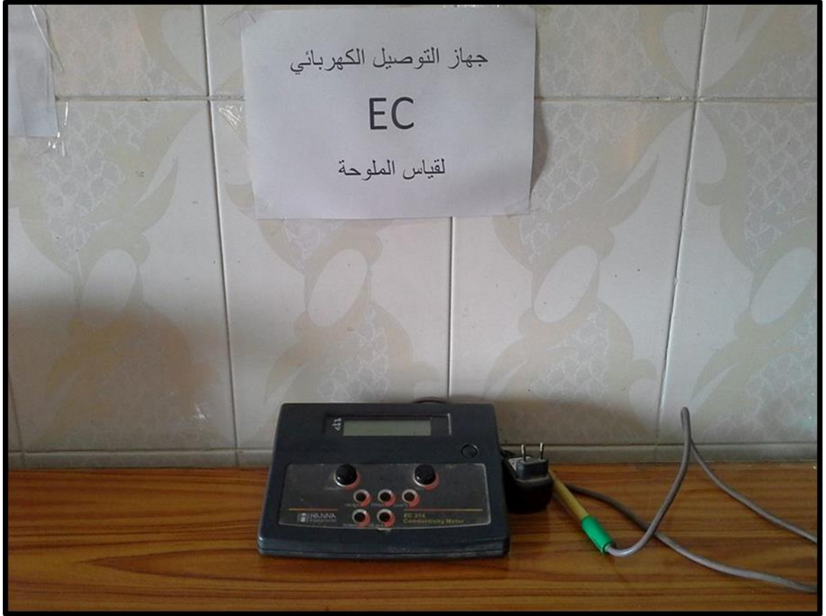
شكل (٣) جهاز قياس التوصيل الكهربائي EC-meter
