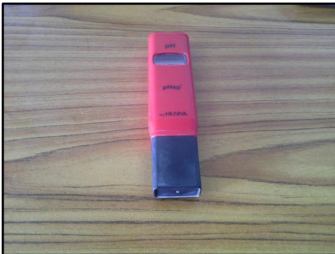
شكل (٤) جهاز PH-meter
