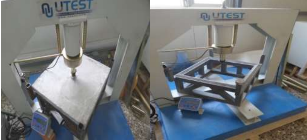
الشكل (6) تفاصيل طريقة اسناد وتسليط الحمل للبلاطات بواسطة جهاز فحص الإنثناء. النتائج والمناقشة :
